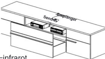
Der IR Repeater leitet die Signale von handelsüblichen IR Fernbedienungen ins Möbelinnere. Es können so z.B DVD-Player hinter geschlossener Front bedient werden. Ankommende IR-Signale werden über den Empfänger aufgefangen, und über den Sender ins Möbelinnere weitergeleitet. Der Repeater benötigt keine eigene Fernbedienung. Zum Betrieb ist ein Netzanschluß mit 220 Volt erforderlich.<br><br>IR=infrarot |
