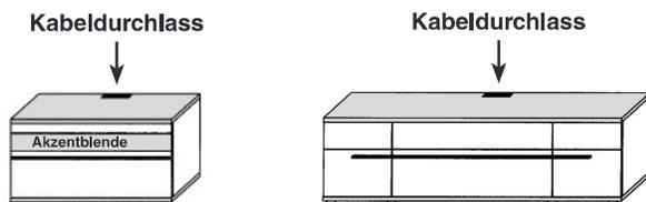
Der Kabeldurchlass verfügt über eine Klappe und eine Dichtbürste zur einfachen Kabelführung!
